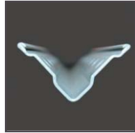
завальцованный край увеличивает жёсткость стойки
